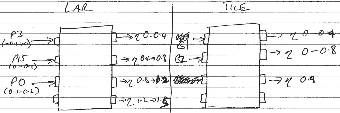
FOR LOW ETA BEAM, USE THE UPPER OUTPUTS OF THE RECEIVER
